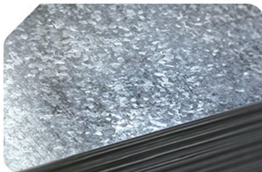
ورق گالوانیزه از پوشش ورق فولادی با فلز روی (Zn) ایجاد شده که این ورق دارای مقاومت در برابر زنگ زدگی و خوردگی می‌باشد. از ورق گالوانیزه در صنایع ساختمانی، آبرسانی، شیروانی منازل و هر جا که احتمال خوردگی آهن و خسارت وجود دارد، استفاده می‌شود. این ورق‌ها عموماً از ضخامت  $\frac{3}{16}$  میلیمتر تا  $\frac{6}{16}$  میلیمتر در عرض‌های  $\frac{1}{2}$  تا  $1\frac{1}{2}$  متر در انواع برند داخلی از جمله هفت الماس و انواع برند خارجی در بازار عرضه می‌گردد.
